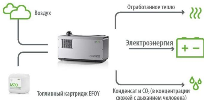
**Топливные ячейки по технологии DMFC являются идеальным решением в области автономного энергоснабжения, в том числе и для мобильного оборудования**
