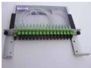
NC-1000 модуль со сплиттерами 1x32 SC/APC
