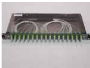
NC-2000 модуль со сплиттерами 1x64 SC/APC
